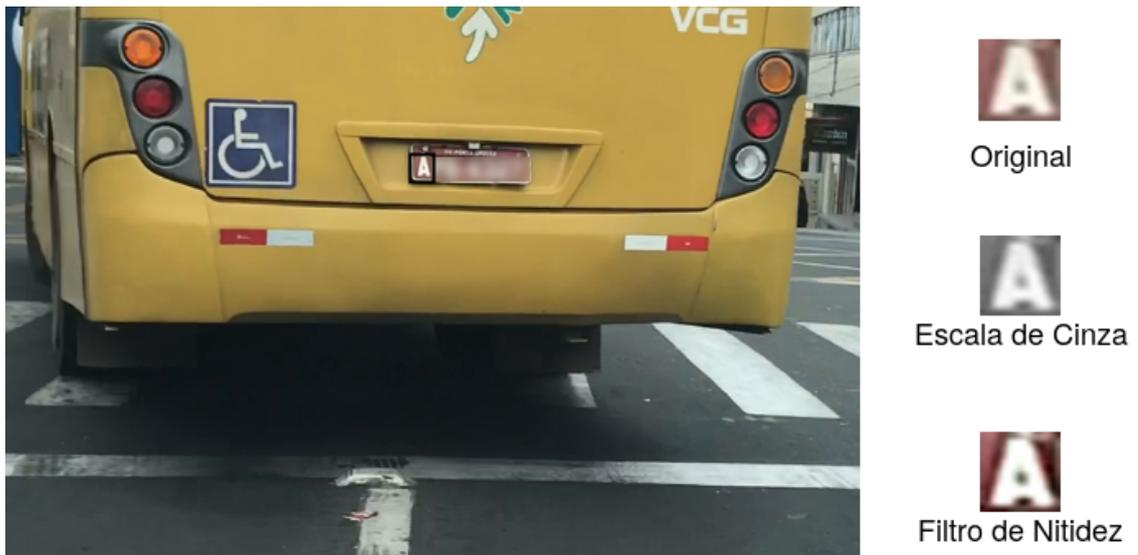
Figura 4.6: Um exemplo demonstrando os efeitos utilizados após o recorte para aumentar a quantidade de dados de letras nas bases de treinamento e validação. O restante da placa foi borrado por questões de privacidade.
