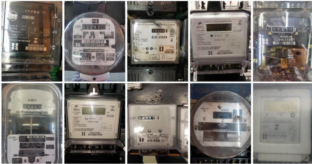
Figura 4.2: Alguns exemplos dos diversos medidores contidos na base de dados utilizada. A UFPR-AMR contém tanto contadores analógicos quanto digitais, além de apresentar fotografias com reflexos sobre determinados locais do medidor, incluindo os contadores. Imagem de Laroca et al. (2019)
